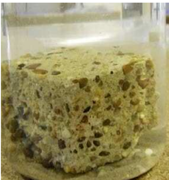
Béton après 6 mois dans l'acide chlorhydrique
